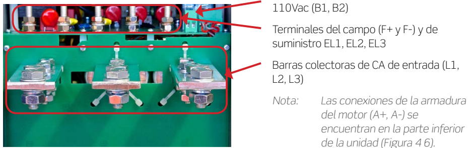
Figura 4-5: Conexiones superiores - Bastidor 3
